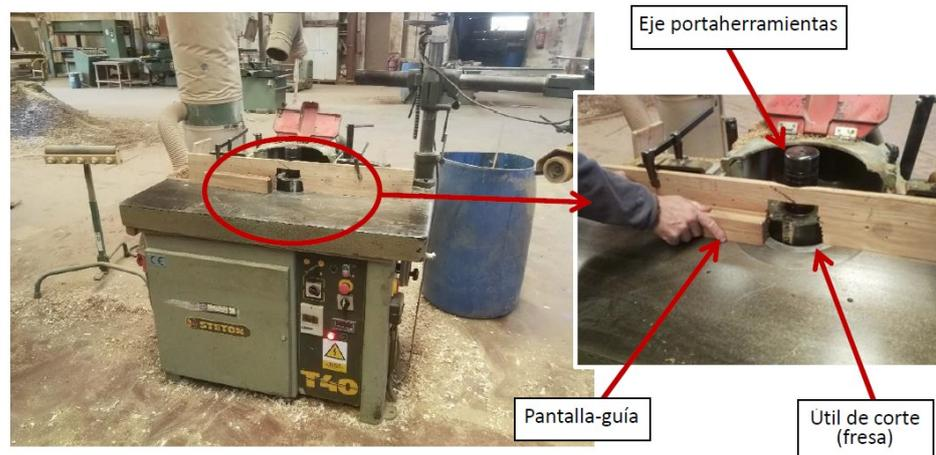
Fotografía 1. Elementos de la máquina tupí. INVASSAT
